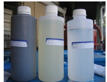
Figura 3.8. Muestras llevadas al laboratorio. El envase de la izquierda contiene agua tratada con una concentración específica de permanganato de potasio, coagulante y floculante. La muestra de la derecha contiene agua tratada con una concentración mayor de permanganato de potasio, coagulante, floculante y carbón activado.
